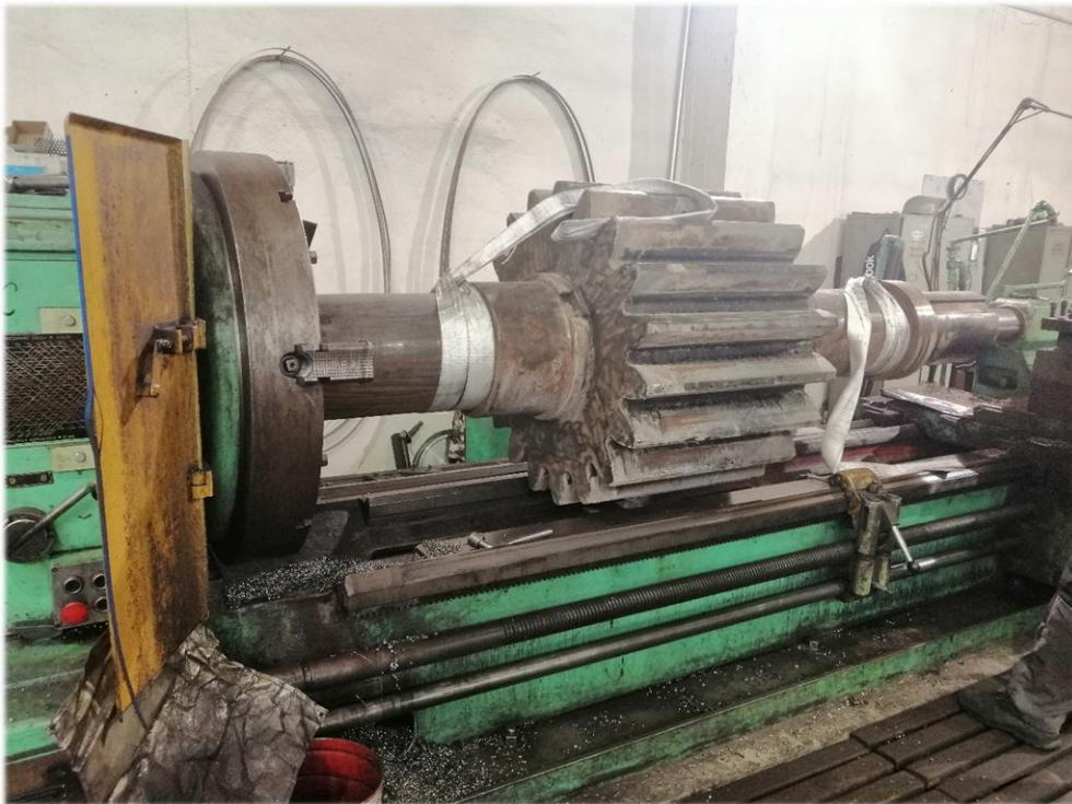
Regeneracje części, koło napędowe pieca obrotowego cementowni
