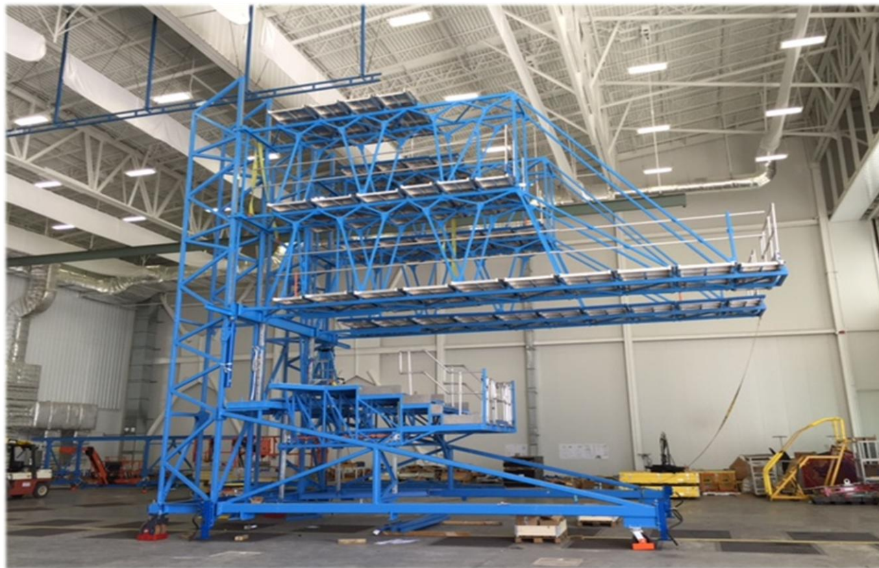
Podest obsługowy samolotu Airbus
